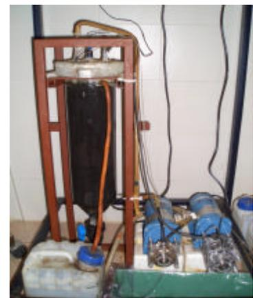
**Figura 6.** Reactor con BSR y etanol como fuente de carbono
