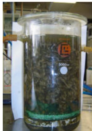
**Figura 7.** Reactor con BSR y celulosa como fuente de carbono
